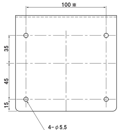
※上図は、『ver.3.0』以降の製品用の寸法図です。それより前のバージョンの製品の場合は、寸法が異なりますのでご注意ください。前のバージョンは、「106mm」になります。
